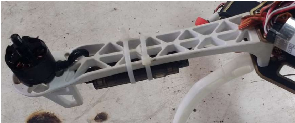
Figura 7 – Um dos braços do drone , sem a hélice. Em destaque, a posição e fixação do ESC. Nos modelos criados, ele foi simulado em uma posição mais próxima ao centro.
